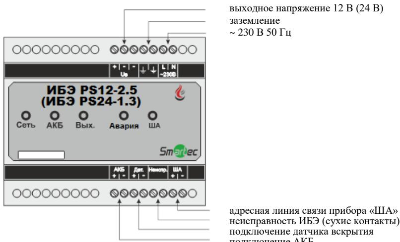
Рис. 3. Расположение контактов ИБЭ исполнений PS12-2.5 и PS24-1.3.
